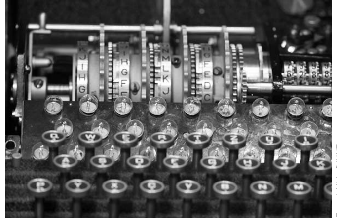
Bild 6: Tastatur und Rotationsscheiben einer ENIGMA.
